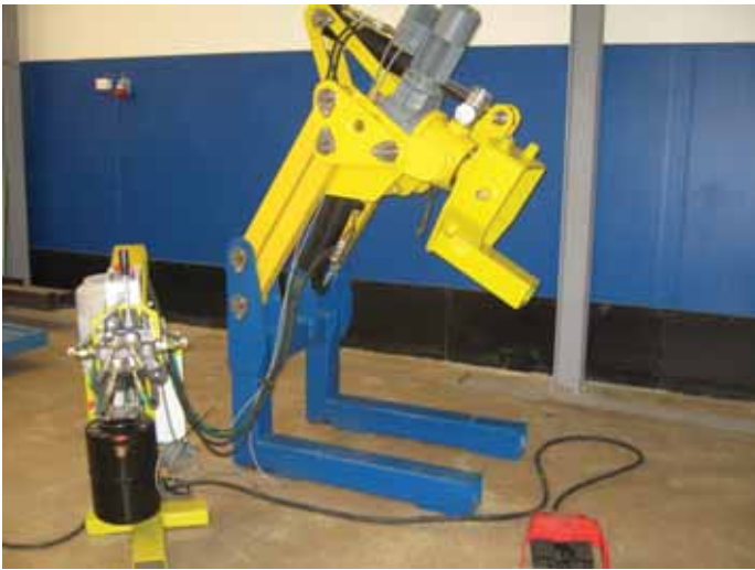
Kuvassa tuotannon apuvälineeksi valmistettu asiakkaan toiveiden mukainen hitsauspyörin.
